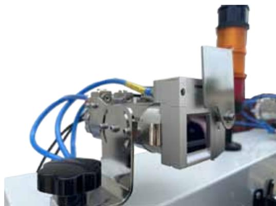
Modulo TERMOCAMERA completamente protetto da chassis in acciaio resistente alle alte temperature.
