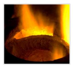
Polveri di copertura, isolanti ed esotermiche, espandibili per la copertura dei montanti.
